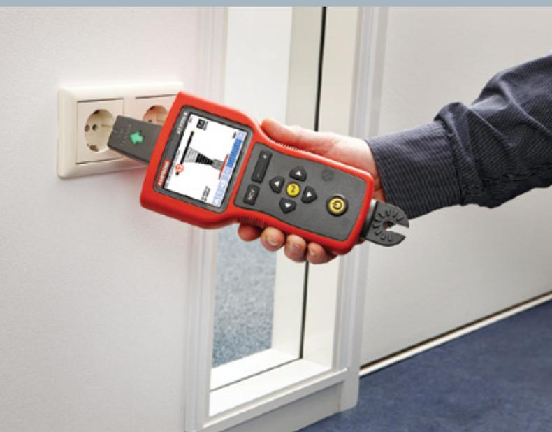
Los localizadores de cables son útiles para el rastreo y la búsqueda de cables y conductores.
