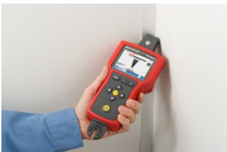
Use el sensor de punta para rastrear cables en zonas de difícil acceso.
