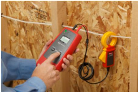
Induzca la señal con la pinza amperimétrica si no hay ningún conductor desnudo.
